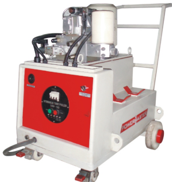
TPP-50 Станция насосная с электроприводом
